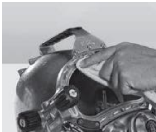
更换面镜 O 形圈前，先清洁 O 形圈凹槽
