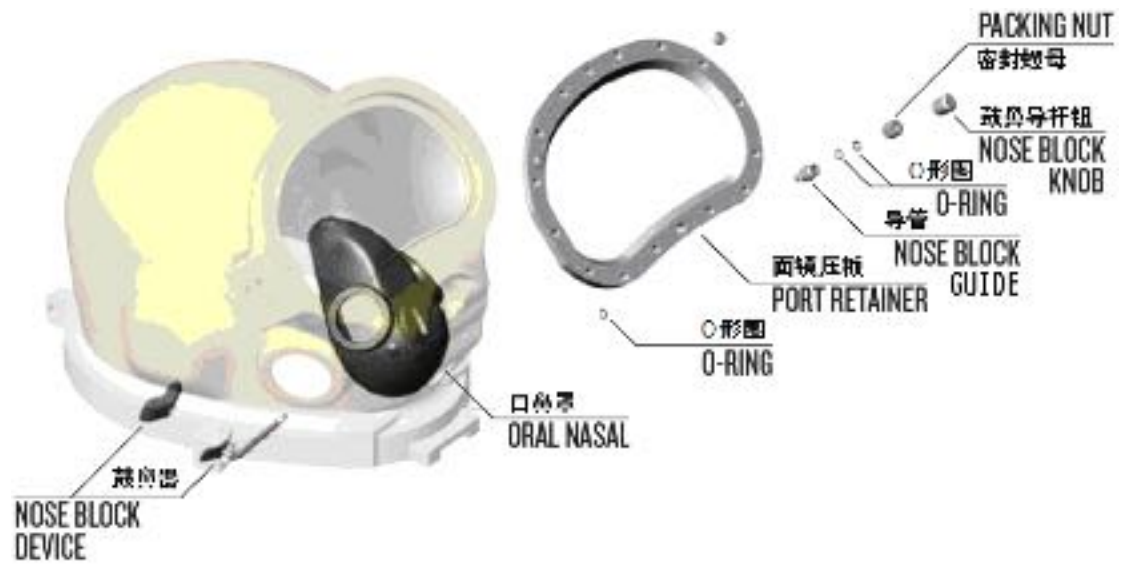
鼓鼻器和相关零件装配示意图（KMB 面罩相同）
