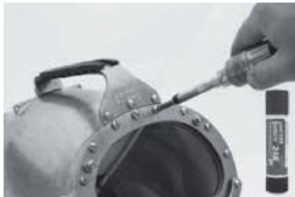
必须使用力矩螺丝刀来测试面镜压板螺钉的松紧程度
