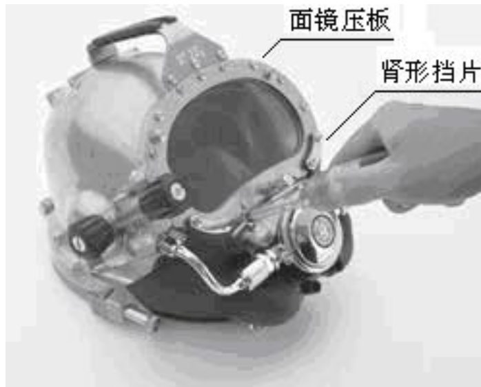
用螺丝刀卸下固定面镜压板上的螺钉
