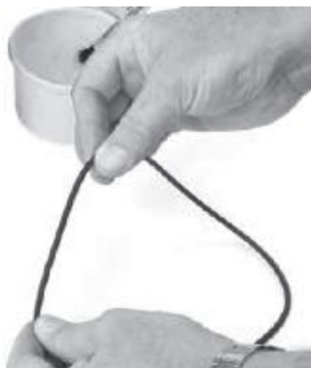
在将O形圈装入凹槽前，先在O形圈上涂上润滑脂
