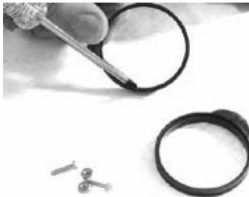
注意排气罩卡箍内侧的凹边，凹边朝向必须正确才能完全紧固住排气罩
