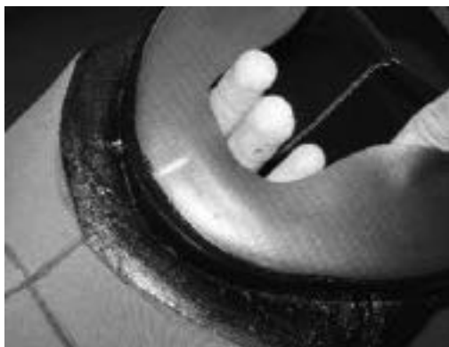
从底部两面的中心开始将面部密封粘接到头罩上
