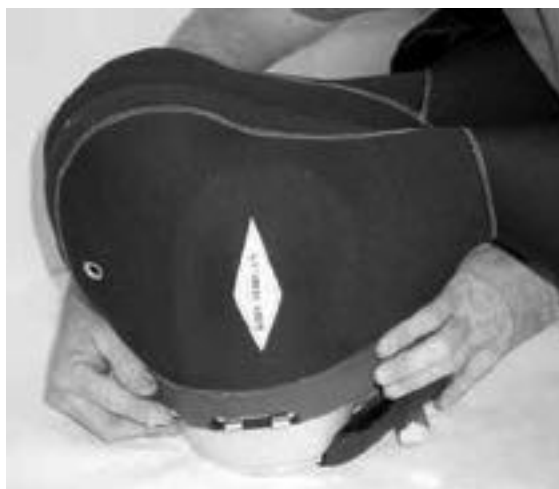
将头罩及夹箍安装到面罩构架上
