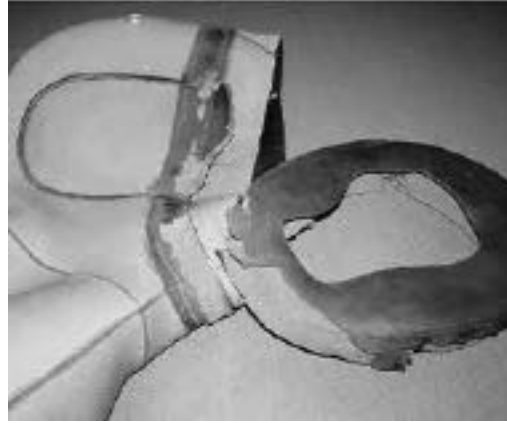
清除掉旧面部密封的全部残留物
