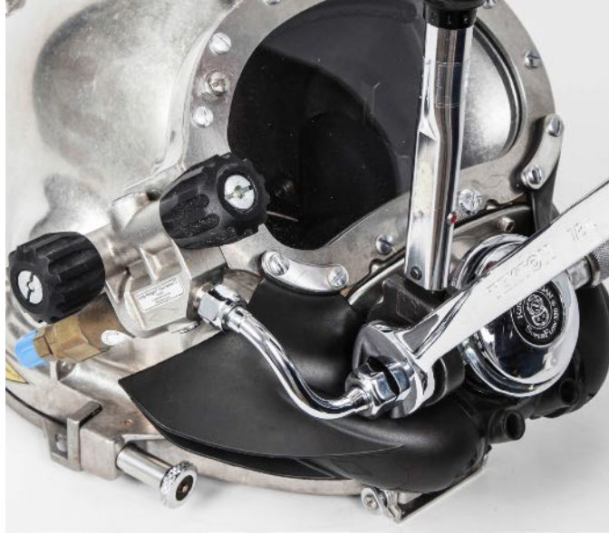
用正确的扭矩值上紧锁紧螺母，扭矩值见附录 APNDX-19 “扭矩要求”
