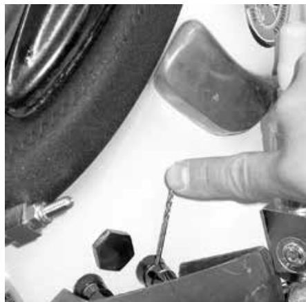
确保接线柱上的插孔完全的对齐，这样在准备潜水时可以轻易地将通讯电线穿过。
