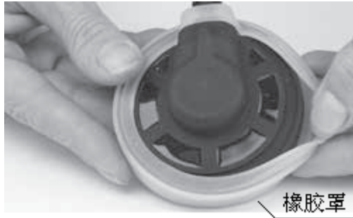
从耳机上拆下橡胶罩
