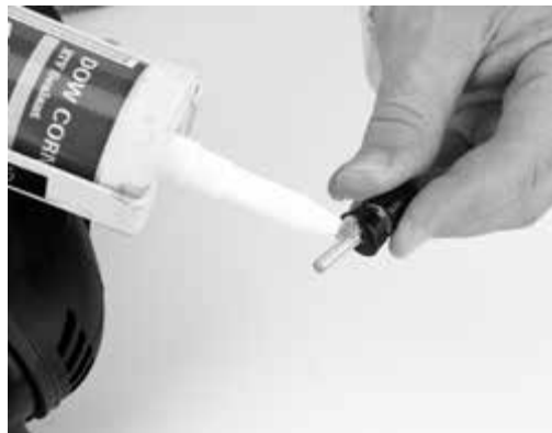
在接线柱合适的位置涂抹上硅酮密封胶用于密封
