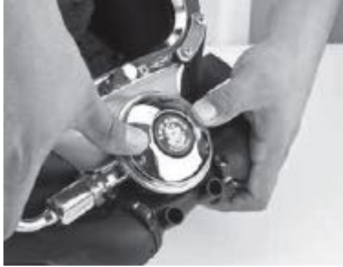
模拟卡箍卡紧的状态用手指按下呼吸调节器前盖
