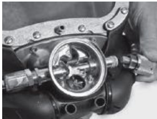
拧出呼吸调节器调节旋钮以备拆卸
