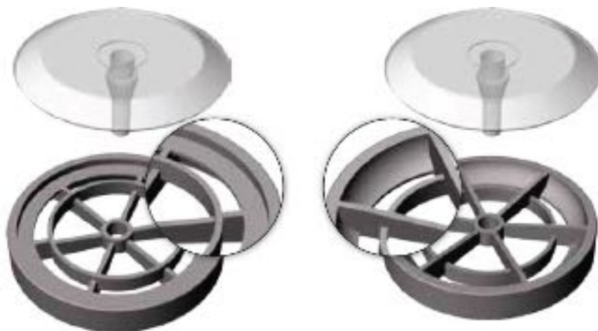
卸下呼吸调节器前盖，检查大膜片
