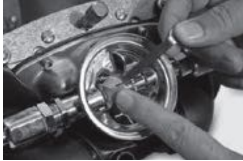
用KMDSI呼吸调节器专用扳手圆盘端向下弯曲摇杆
