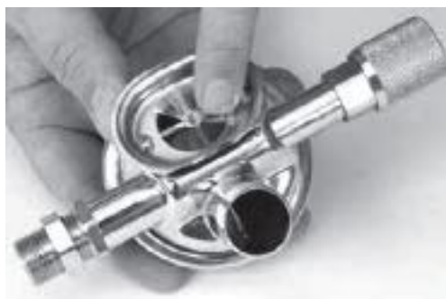
排气膜片阀必须状态良好
