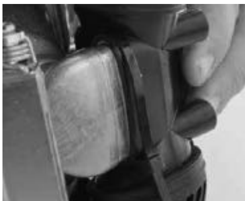
将排水阀转接器插入四通排气阀扁接口内
