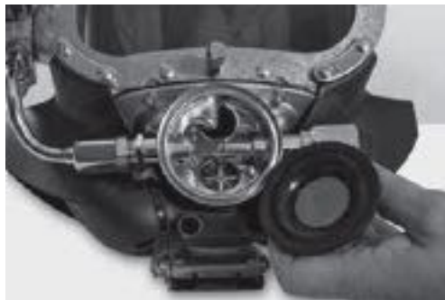
卸下呼吸调节器前盖，检查大膜片
