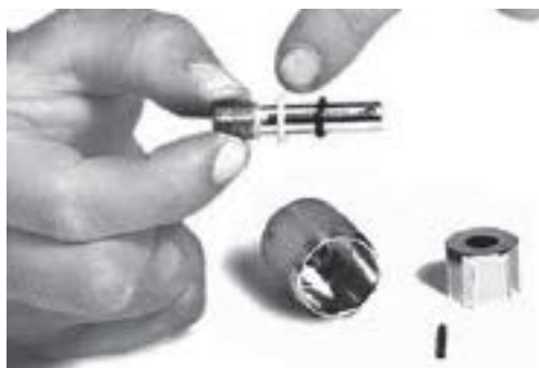
检查垫圈和O形圈
