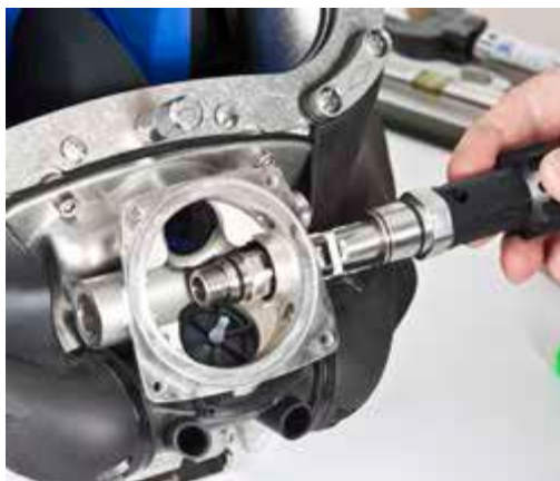
当拉出调节旋钮组件时，主管及相关零件将随之出来
