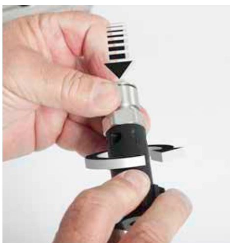
逆时针转动调节旋钮的同时，推动调节杆去对接螺纹
