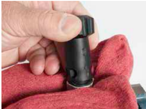
拆下调节杆后才能将调节旋钮与密封螺母分离
