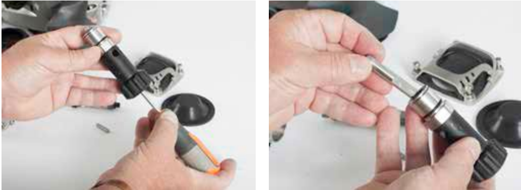
必须先将调节杆完全拆下来，再卸下调节旋钮
