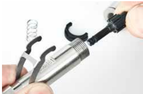
进气阀安装到位后，捏住摇杆的两臂，慢慢取出平衡垫和O形圈
