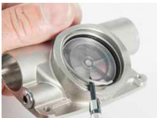
从呼吸调节器壳体中拆下排气阀阀座卡环
