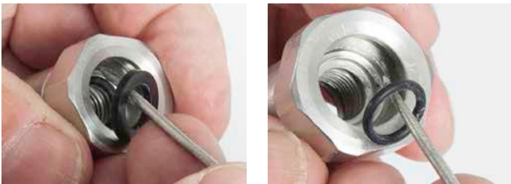
使用O形圈钎子小心地取下支承垫圈和调节杆O形圈
