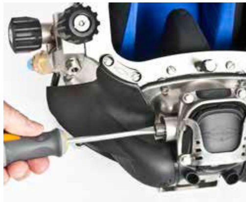
每次只能转动调节套管1/16圈来调整呼吸调节器供气性能
