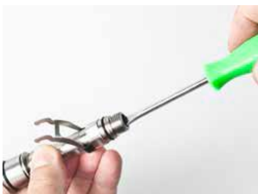
用一只平头螺丝刀慢慢地将调节套管拧进主管
