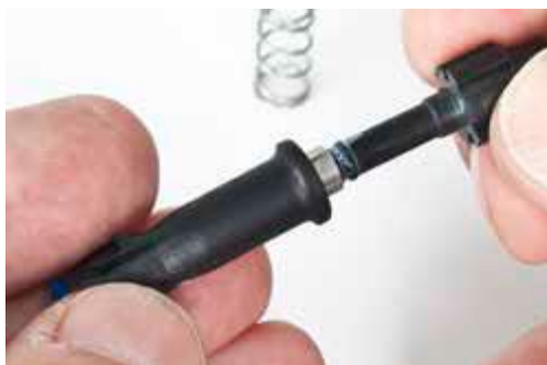
用已装上两个O形圈的平衡垫，将第一个O形圈插入进气阀的开口端
