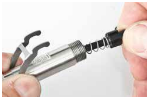
将弹簧和装上O形圈的平衡垫装入主管内
