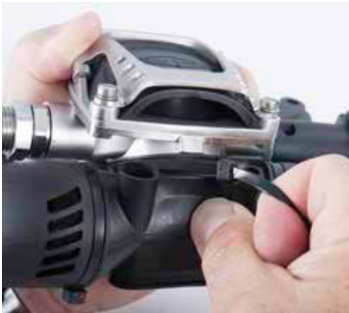
在呼吸调节器上装上扎条，并剪掉扎条的多余部分
