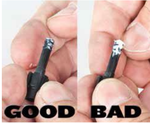
不要过度润滑平衡垫上的O形圈
