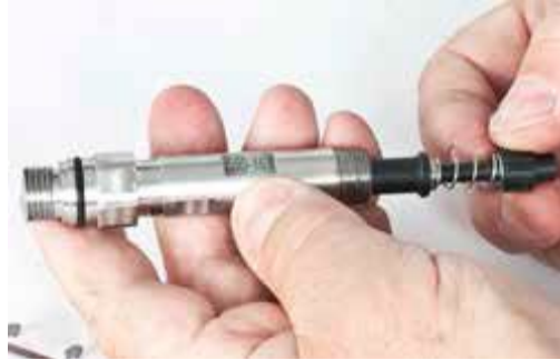
从主管中抽出平衡垫、弹簧和进气阀组件
