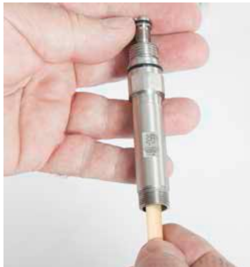
从主管上拧松（向“外”转）调节套管，再用木销棒将其推出来
