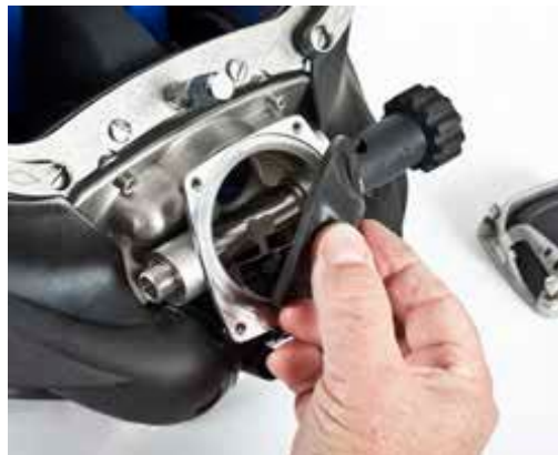
卸下大膜片并仔细检查，如果膜片有破裂或破孔则必须更换
