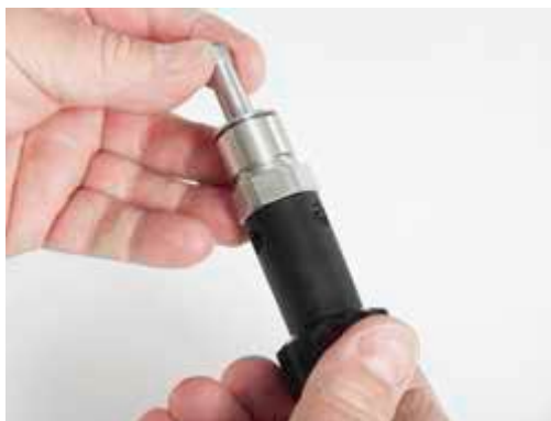
用Christo-Lube®润滑剂润滑调节杆上的螺纹，然后将其插进调节旋钮
