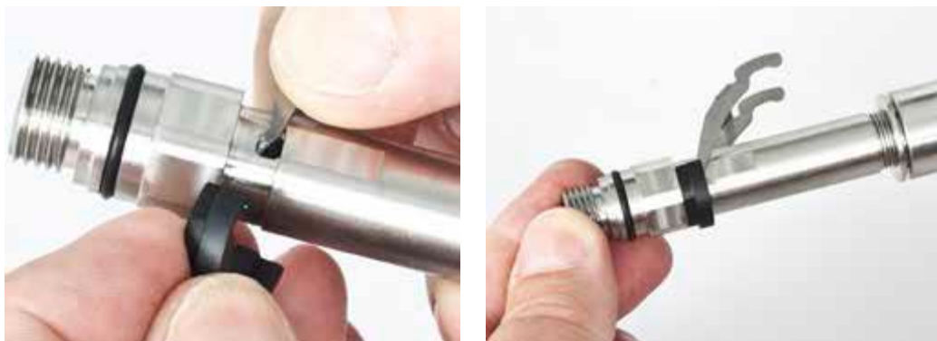
将支撑夹装到主管外侧面上
