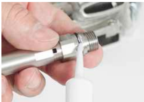
将O形圈装到主管上，用Christo-Lube®润滑O形圈
