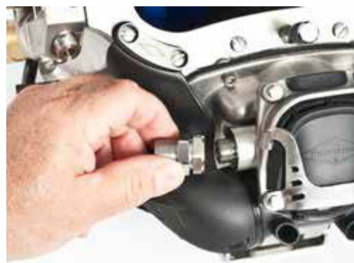
卸下弯管转接头
