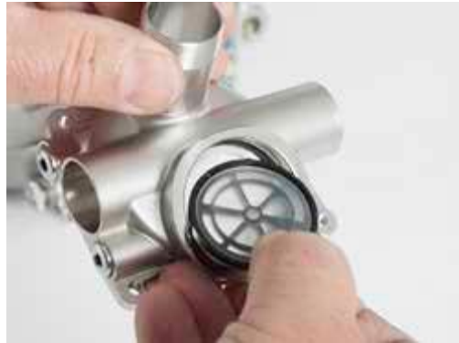
拆下排气阀阀座组件
