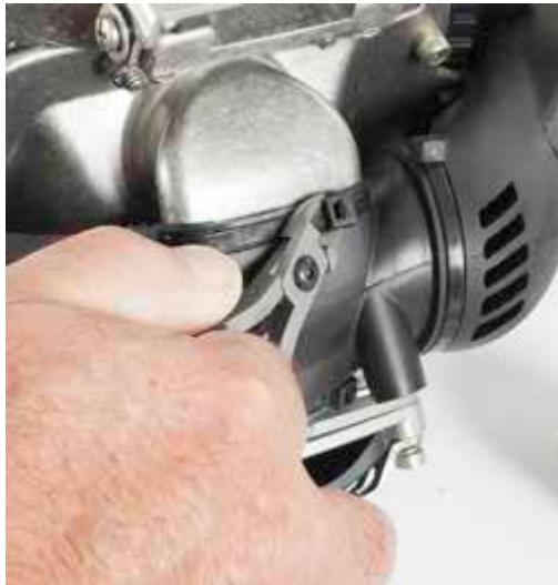
剪断固定呼吸调节器壳体与头盔前舱盖上排水管的扎条
