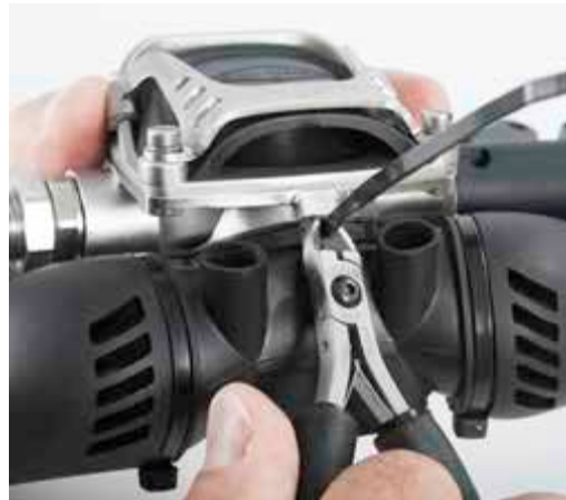
在呼吸调节器上装上扎条，并剪掉扎条的多余部分
