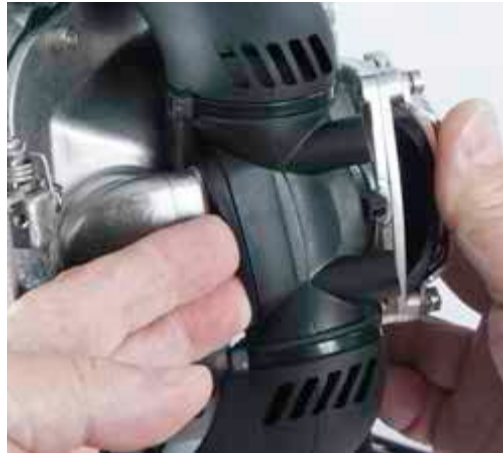
将主排气阀体上的扁口管套在头盔前舱盖相对应的扁口上
