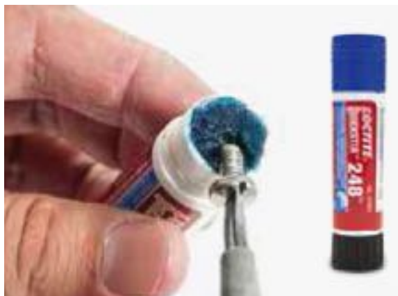
在螺钉上涂上Loctite®248螺纹防松脂
