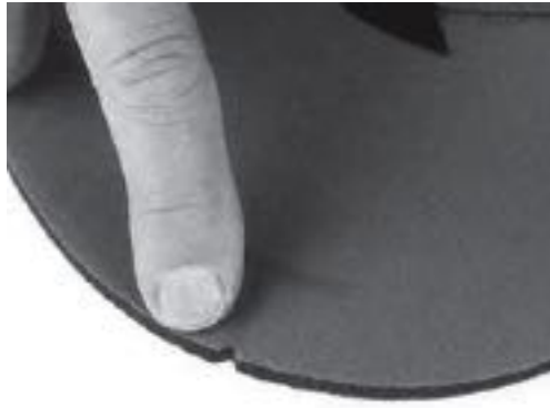
颈箍底边有V型缺口标记，用于对齐开口环的接口
