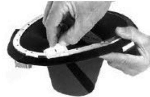
用锋利的刀片切割多余的氯丁橡胶
