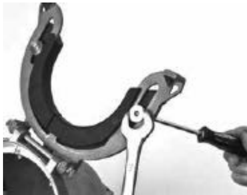
拧下固定颈垫的两个螺钉
