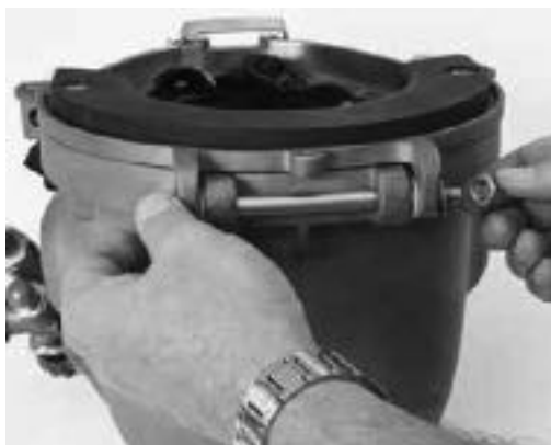
螺栓末端应伸出超过Nylock衬套的末端
