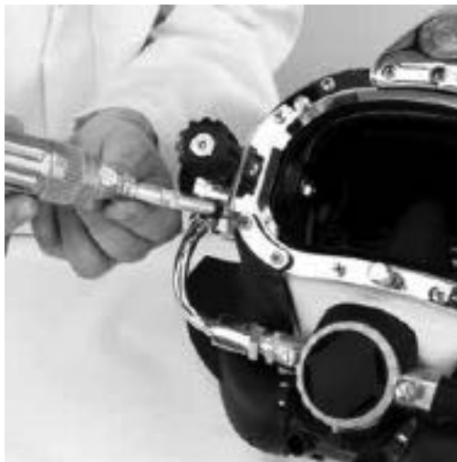
将固定排气罩的螺钉拧紧到头盔上
