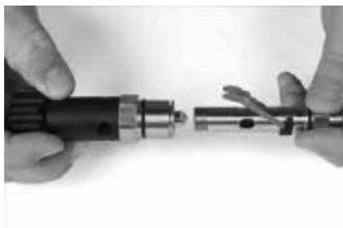
将调节旋钮组件拧到主管上
