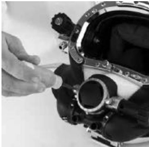
卸下前盖两侧的螺钉和垫圈
