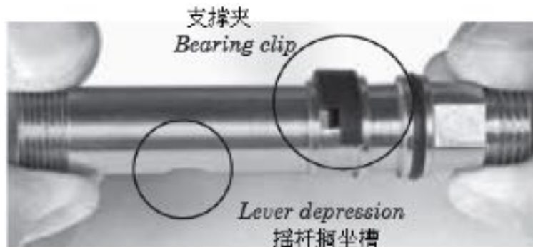
注意支撑夹在主管上的正确安装位置
