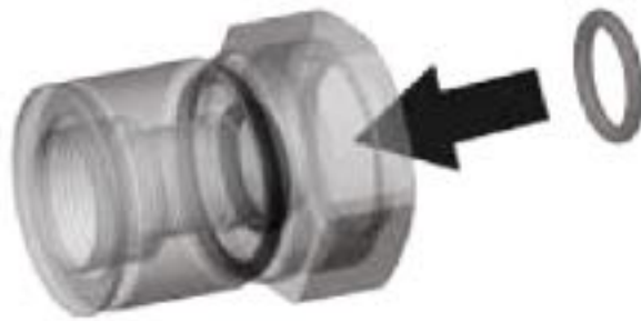
将小O形圈装入密封螺母的内槽里
