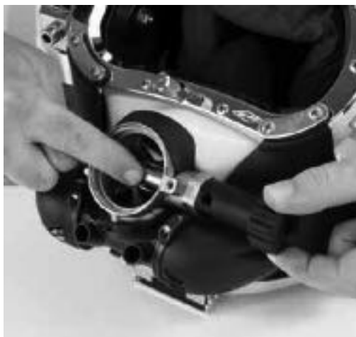
必须向下压住摇杆才能卸下所有主要零件（类似组装）
