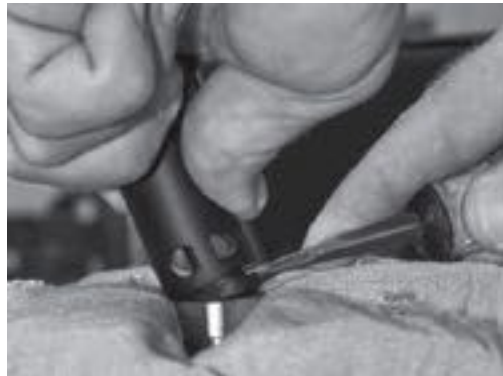
台钳夹住密封螺母，用宽槽螺丝刀将调节旋钮凸台推入密封螺母中
