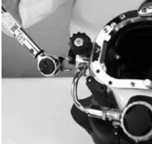
连接弯管组件并拧紧弯管两端的螺母
