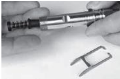
从主管上卸下平衡垫、进气阀和阀座
