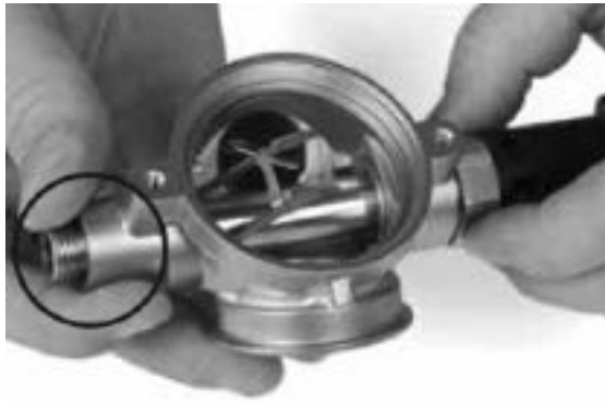
主管的螺纹端应当伸出呼吸调节器壳体侧面的管口
