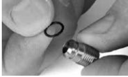
在调节套管上装上O形圈
