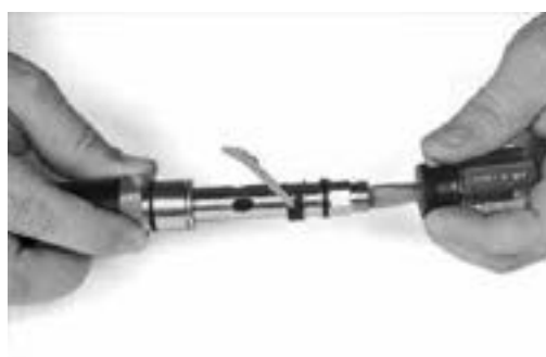
将调节套管拧进主管的开口端
