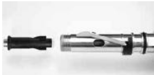
将进气阀插入主管内
