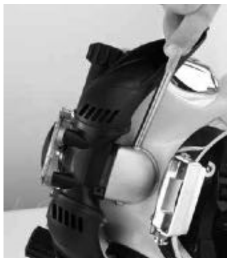
将连接四通排气阀盖与主排气阀体的螺钉拧紧
