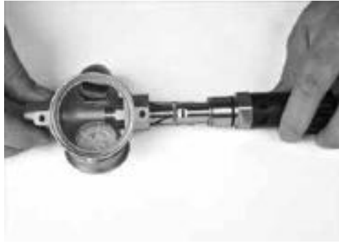
将主管及关联部件插入呼吸调节器壳体内
