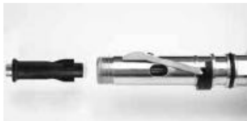
将进气阀装入主管
