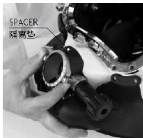
确保将隔离垫装在呼吸调节器圆管上
