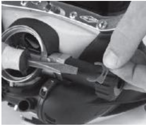
要维护呼吸调节器内的O形圈，必须卸下锁夹
