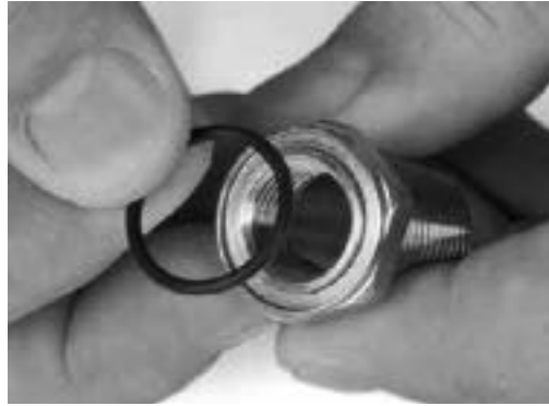
将O形圈装入弯管接头内
