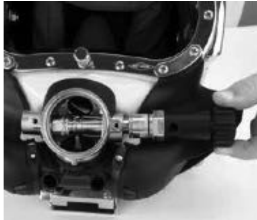
拉出调节旋钮组件时主管及相关零件随之出来
