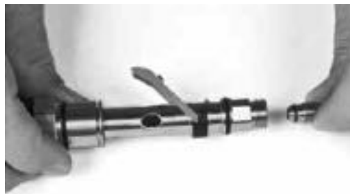
将调节套管拧进主管内
