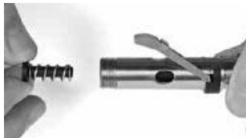
将平衡垫及弹簧插入主管内。安装正确时，平衡垫应与进气阀吻合在一起
