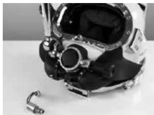
卸下弯管和呼吸调节器进气口上的弯管接头
