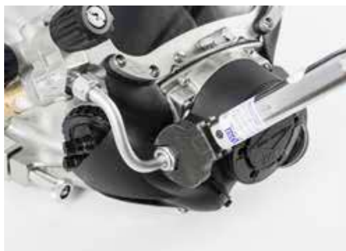
确保弯管与呼吸调节器连接紧密、扭矩正确
