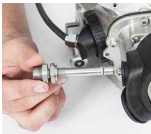
安装进口螺纹套管
