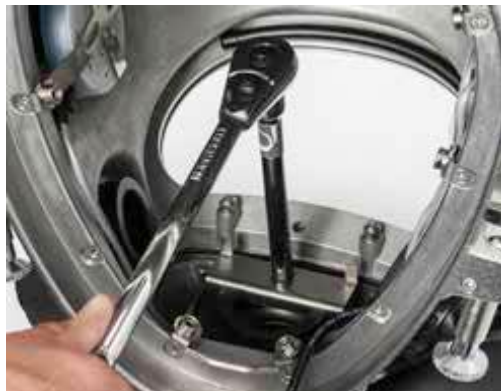
用扭矩扳手上紧呼吸调节器安装螺母，正确的扭矩值见附录 APNDX-19 “扭矩要求”
