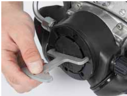
旋开固定环开始拆卸前盖
