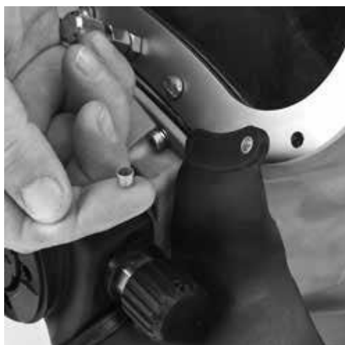
在拧紧排气罩固定螺钉前确保排气罩小衬套安放到位
