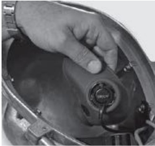
麦克风必须从口鼻罩中拆下
