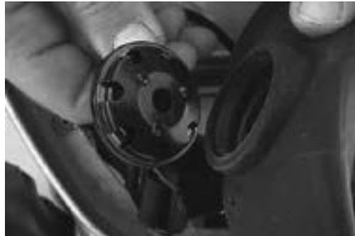
将麦克风装进口鼻罩
