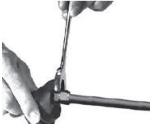
用3/4英寸扳手拧下水密连接器
