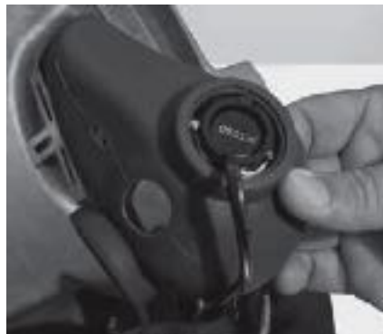
良好的通信对于潜水员的安全至关重要，应定期检查通信系统的零部件，必要时更换
