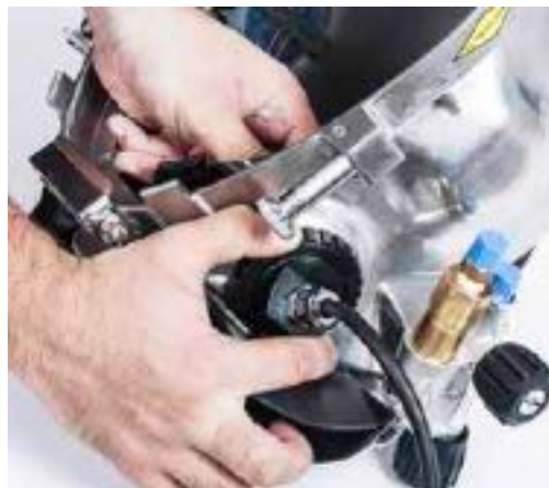
固定螺母只能用手拧紧且必须可靠地将模件固定在恰当的位置
