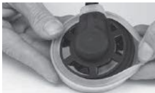
从耳机上拆下橡胶罩
