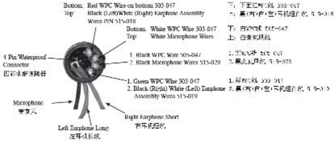
正确的水密连接器与耳机电线连接图
