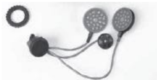
模块化的通信系统便于快速更换
