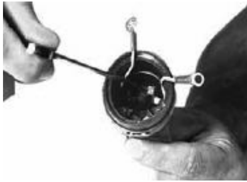
用扳手拧紧通信接线柱螺母
